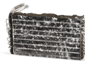
Sin mantenimiento del sistema de A/A
