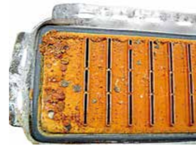
Corrosión debido a un refrigerante erróneo o envejecido
