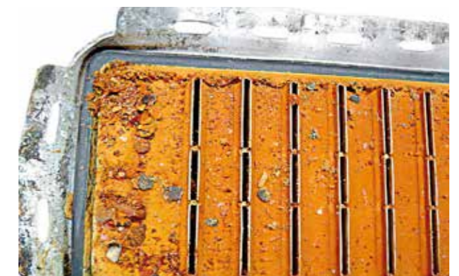
Sedimentos de corrosión en el radiador
