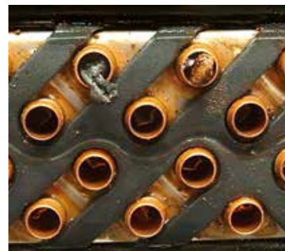
Sedimentos emulsionados en el intercambiador de calor con suplementos de turbulencia
