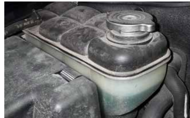
Depósito de compensación
