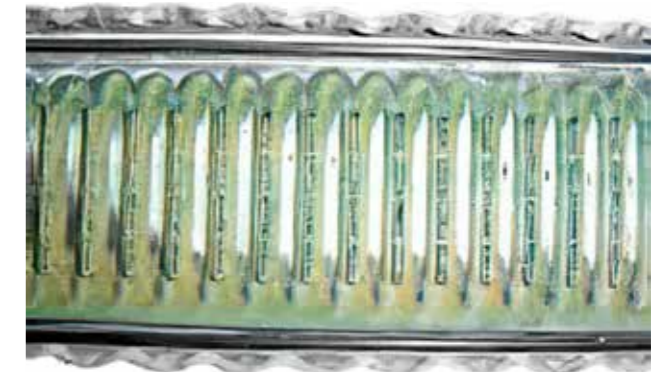
Sedimentos de cal en el radiador
