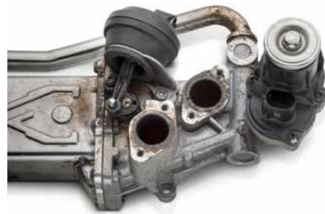
Radiador EGR con micromotor y actuador de presión negativa
