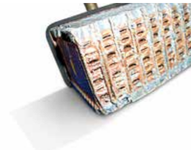
Intercambiador de calor calcificado
