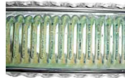
Sedimentos de cal por el uso de agua pura (sin refrigerante)
