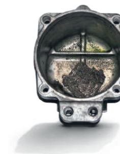
Abrasión en caso de daños en el compresor de A/C
